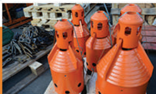
Головка режущая центрирующая полая для труб из хрупких материалов
