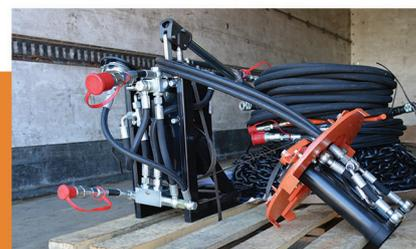
Фиксатор труб гидравлический с насосом
